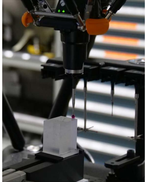
使用Equator比对仪扫描精密楔形零件
