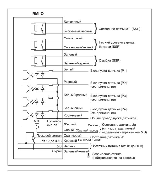
**ПРЕДОСТЕРЕЖЕНИЕ.** Нулевой провод источника питания должен быть подключен к заземлению станка (нейтральной точке звезды). При соответствующем подключении допускается использование минуса питания.
