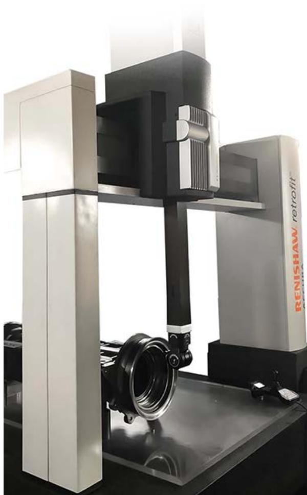
REVO mentre misura un componente cilindrico utilizzato nel settore ferroviario
