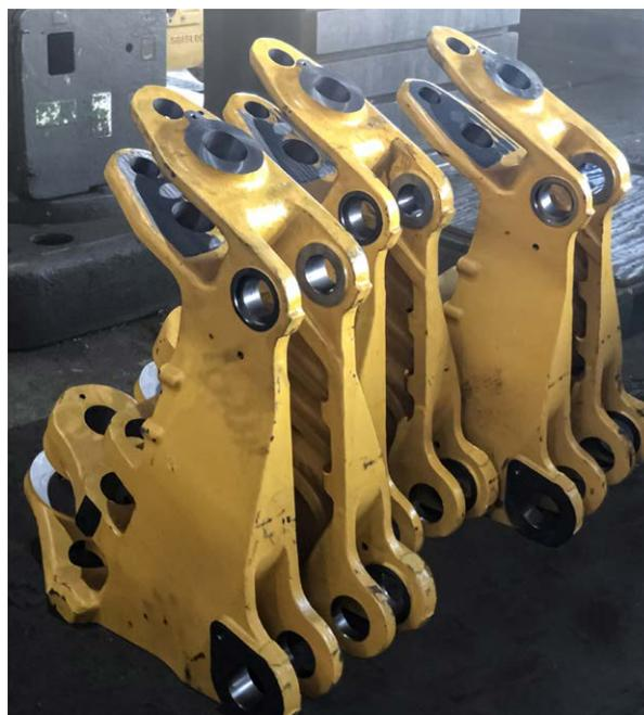
Componenti per telai oscillanti utilizzati su macchine di movimento terra
