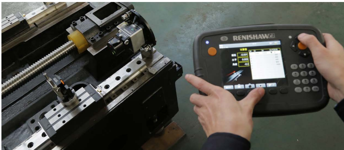
Лазерная система для юстировки ХК10 от Renishaw с технологией беспроводного соединения
