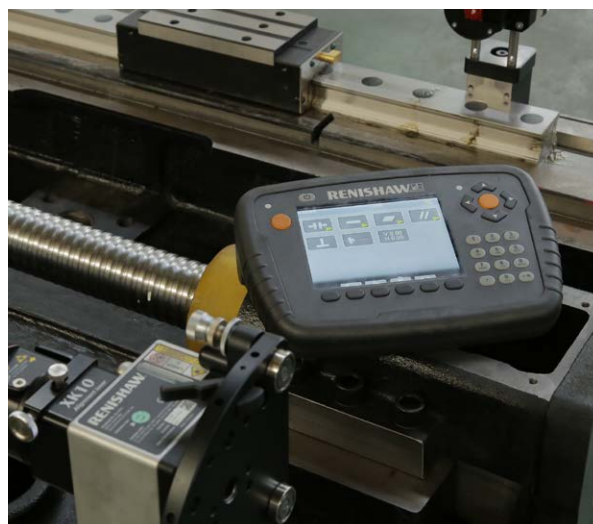
Использование XK10 для контроля параллельности двух направляющих
