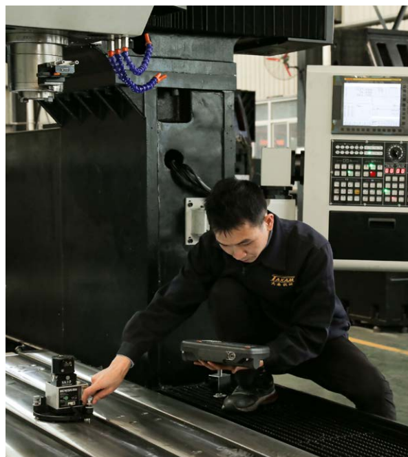
Использование ХК10 для контроля отклонений от перпендикулярности
