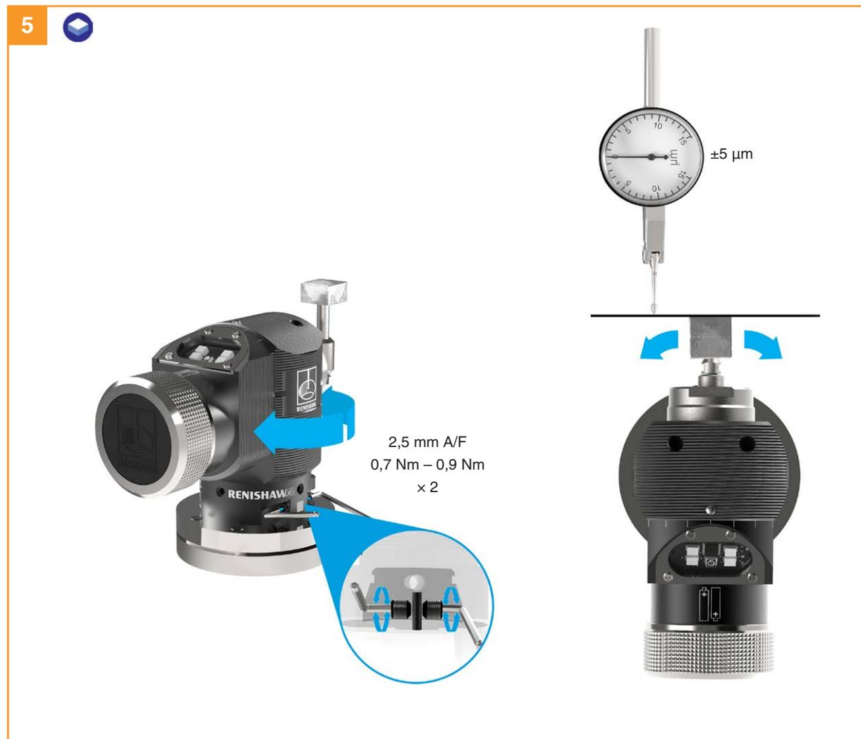
Aperte os parafusos de fixação opostos 3 contra um pino de posicionamento fixado à base.
