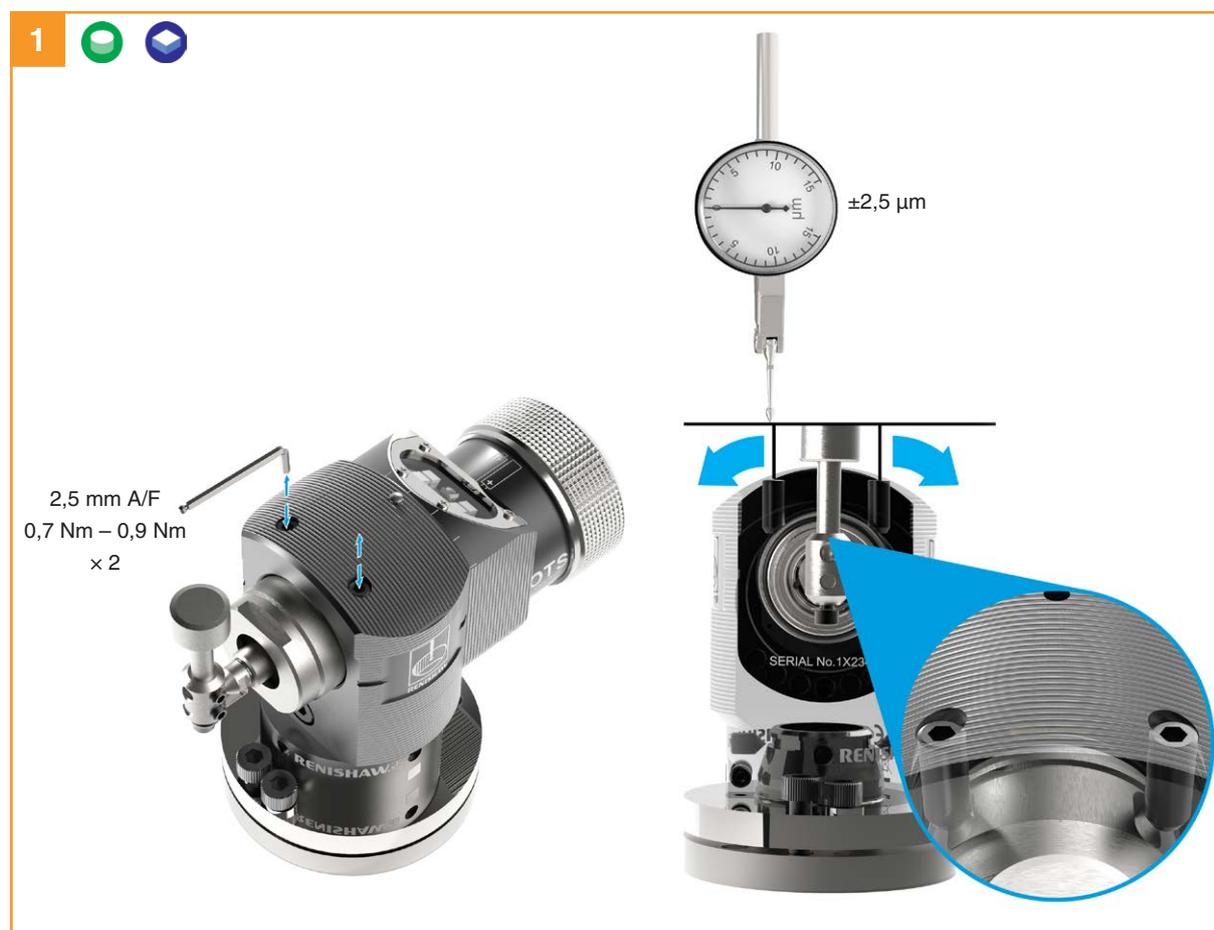
O nivelamento lado a lado é obtido ajustando-se alternadamente os parafusos de fixação, que fazem o módulo do apalpador girar e alteram a configuração de nível da ponta.
