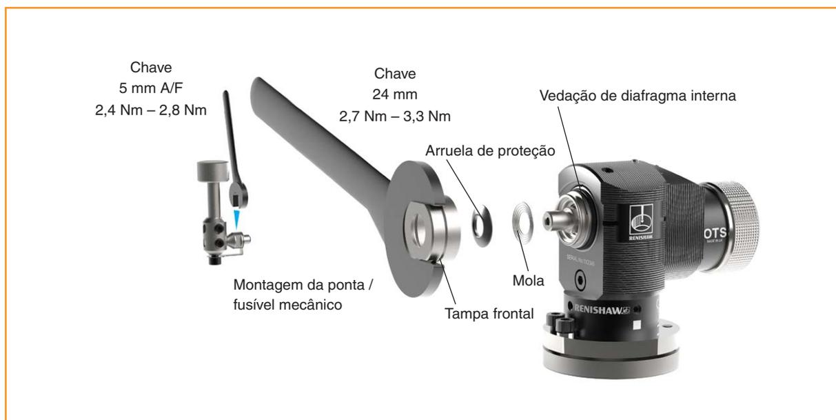
1. Remova o conjunto ponta/fusível mecânico usando a chave inglesa A/F de 5 mm.
