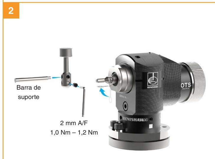
**NOTA:** Sempre mantenha a barra de suporte na posição para neutralizar forças de torção e evitar o excesso de tensão sobre o fusível mecânico da ponta.
