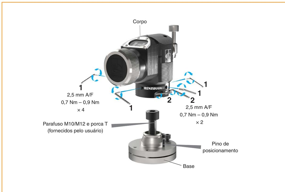
1. Selecione uma posição para o OTS na mesa da máquina. Posicione-o de forma a minimizar a possibilidade de colisão e verifique se o visor óptico está voltado para o receptor.
