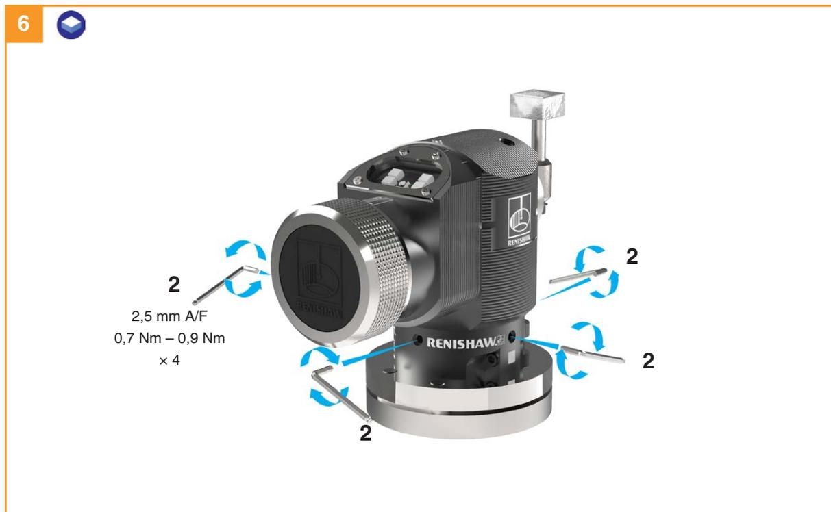
Reaperte totalmente os quatro parafusos de travamento 2 do corpo.
