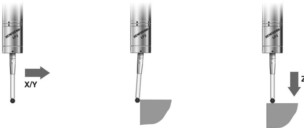
Un segnale di trigger viene generato quando lo stilo della sonda entra in contatto con una superficie. Il controllo della macchina registra la posizione di contatto e impartisce l'arresto della macchina.
