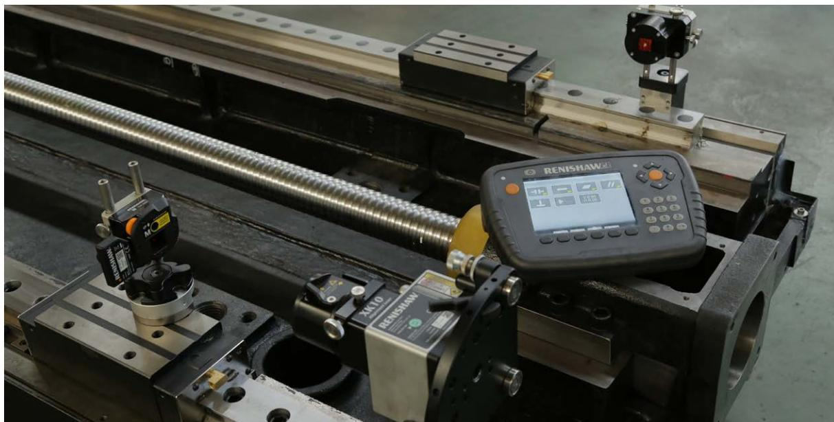
Utilizzo del sistema XK10 per misurare il parallelismo di due guide lineari
