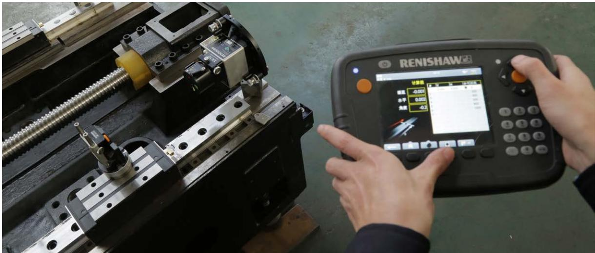
Il sistema di allineamento laser XK10 di Renishaw si avvale della tecnologia di comunicazione wireless
