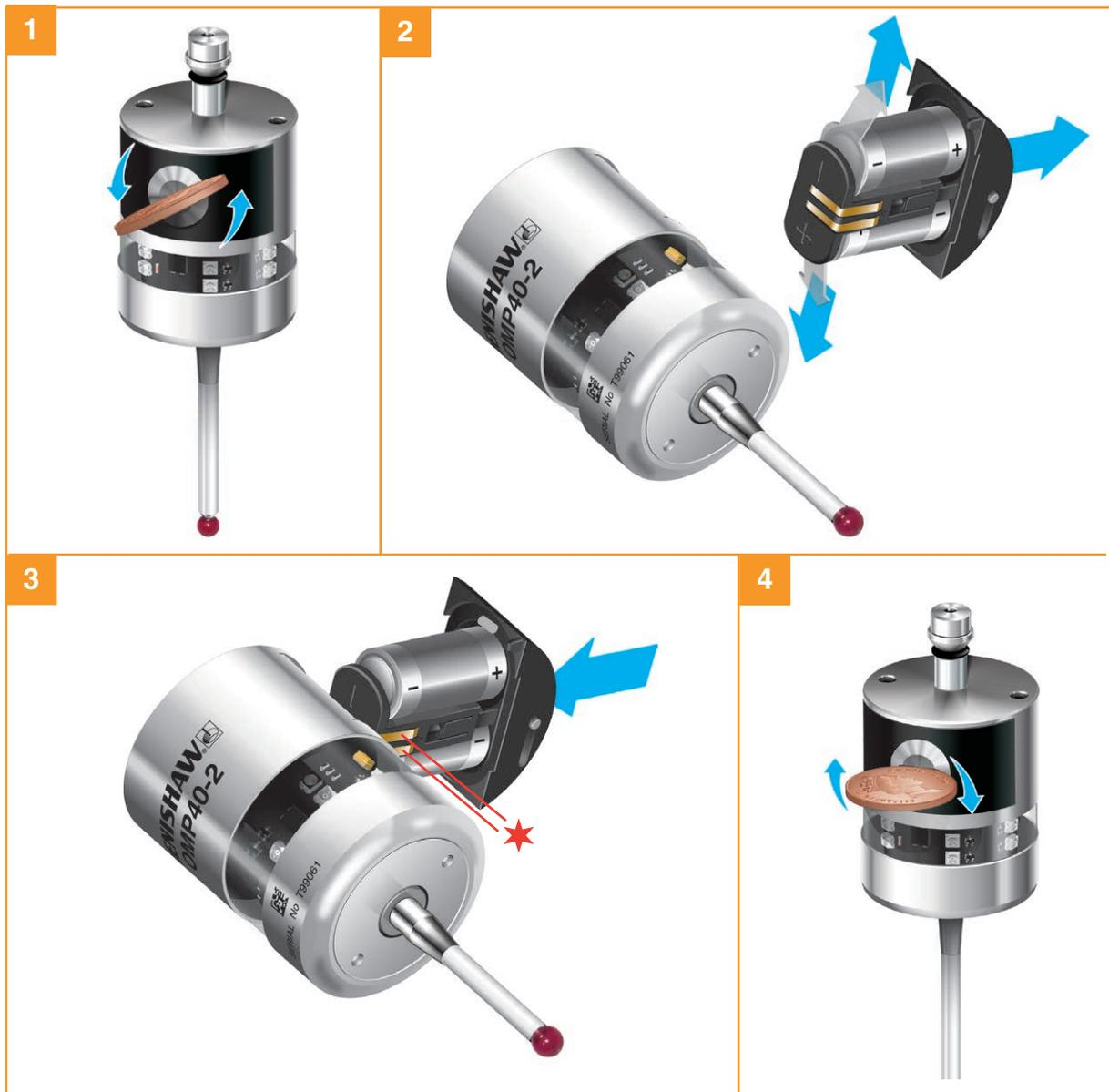
プローブのシャンクへの取付け
