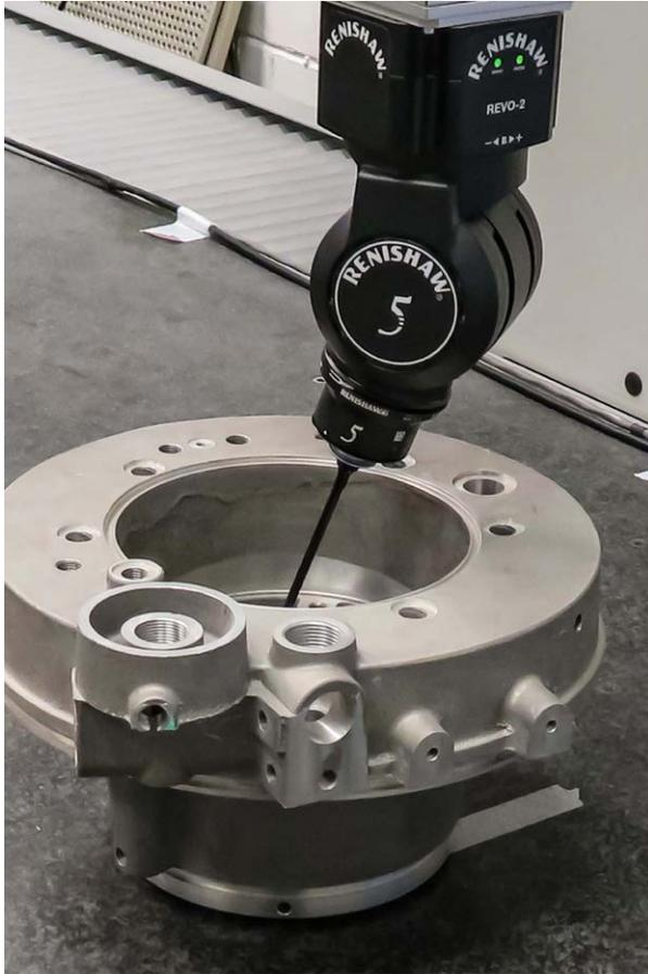
REVO五轴测座提供无级定位能力
