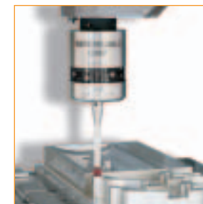
OMP40 – ultrakompaktne vretenaste mjerne sonde za podešavanje i pregled
