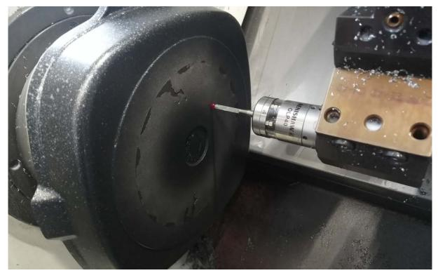
Датчик OLP40 определяет нулевую позицию перед обработкой
