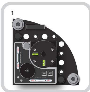
1 Установите пусковой лазерный блок в углу поверхности
