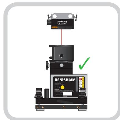
Отрегулируйте блок М так, чтобы он располагался под прямым углом к пусковому блоку
