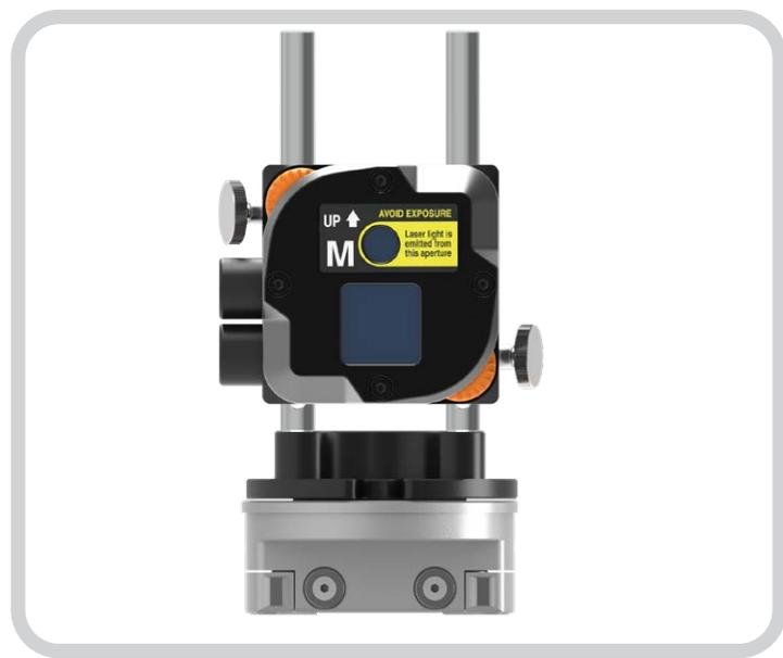
Установите блок М на станину при помощи координатного крепления
