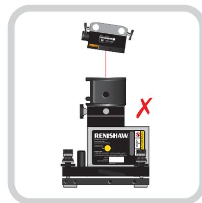
Проверьте, что пусковой блок и приемник установлены под прямым углом друг к другу
