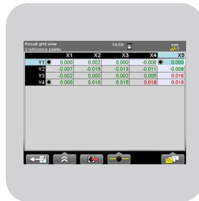
Для создания базовой плоскости выберите 3 базовые точки
