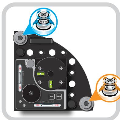
Для регулировки поворотной плиты используйте регуляторы тангажа/рыскания
