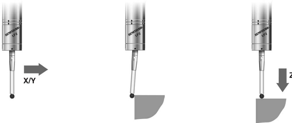
Ein Schaltsignal wird erzeugt, wenn der am Messtaster befindliche Taster beim Anfahren einer Fläche angelenkt wird. Die Maschinensteuerung speichert diese Position und stoppt die Maschinenbewegung.
