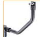
Lo stilo della sonda è effettivamente un punto di riferimento sulla vostra macchina. Gli utensili sono guidati contro lo stilo della sonda quando sono in condizione statica o rotante; quando la sonda scatta, le posizioni degli assi della macchina vengono catturate e viene registrata la posizione del tagliente dell'utensile. Se necessario vengono presi altri punti per determinare le dimensioni dell'utensile.
