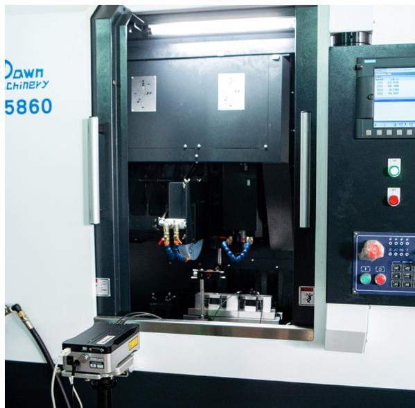
Système d'interféromètre laser XL-80 utilisé pour vérifier la précision dynamique des machines-outils de Dawn Machinery
