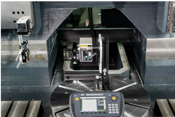
Mesures de rectitude avec système laser d'alignement XK10
