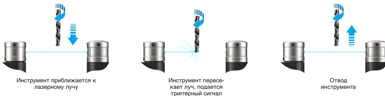
Лазерное устройство класса 2:
