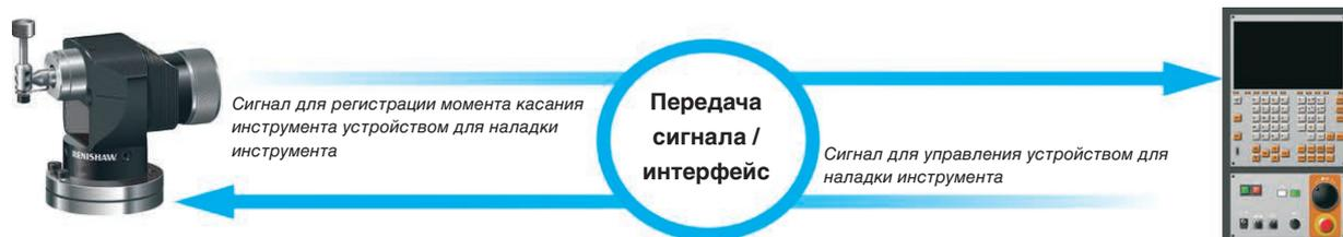
Система передачи сигналов предназначена для того, чтобы связывать между собой датчик и систему ЧПУ станка. Выбор конкретной системы передачи сигнала определяется типом используемого датчика и типом станка, на котором он установлен.
