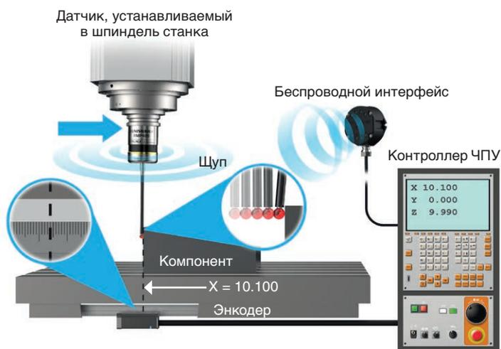
После считывания координатных точек датчик перемещается дальше и срабатывает в другом положении. Выполнение измерений в нескольких точках дает представление о форме и характеристиках. Минимальное количество точек, необходимое для измерения элемента определенного типа (см. справа), зависит от его степени свободы.
