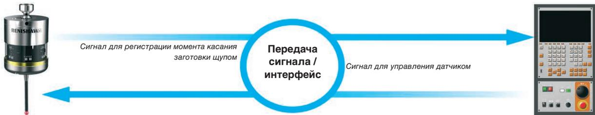
Система передачи сигналов обеспечивает связь между датчиком и системой ЧПУ станка. Ее выбор зависит от типа датчика и станка, а также от выполняемой задачи.
