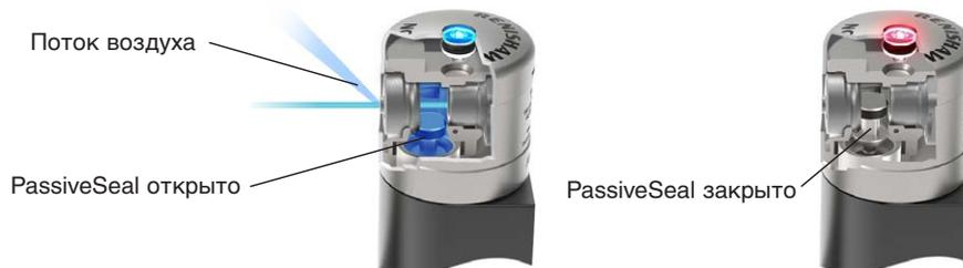
Система PassiveSeal, предназначенная для защиты головок передатчика и приемника NC4, активируется давлением воздуха. В момент подачи воздуха на головку NC4 устройство PassiveSeal опускается, а лазерный луч выходит из MicroHole. В случае сбоя или отключения подачи воздуха PassiveSeal автоматически поднимается и перекрывает MicroHole, исключая попадание СОЖ и загрязнение.
