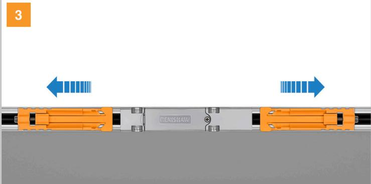
Separe los soportes de alineación de la cabeza lectora y retírelos de la extrusión.
