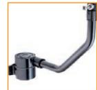
在机床上，测头测针相当于一参考点，测量时程序驱动静态或旋转刀具接近测头测针，当测头触发时，采集机床的坐标位置，刀刃位置被记录。若需要，可进一步采集其他点的坐标，计算出刀具的尺寸。
