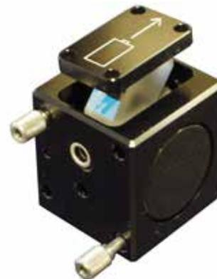
При установке держателя оптики на место проследите за тем, чтобы он состыковался с одной из длинных кромок корпуса, прежде чем будет полностью затянут винт с головкой под ключ. Тем самым будет обеспечена правильная установка оптики внутри корпуса.
