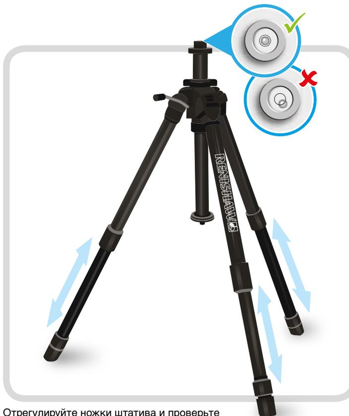
Отрегулируйте ножки штатива и проверьте правильность его установки по горизонтали с помощью пузырькового уровня
