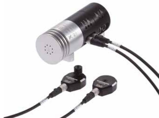
Указанная точность интерферометрических измерений, выполняемых лазерной системой XL, действительна только при использовании откалиброванного блока компенсации изменения параметров окружающей среды XC-80.
