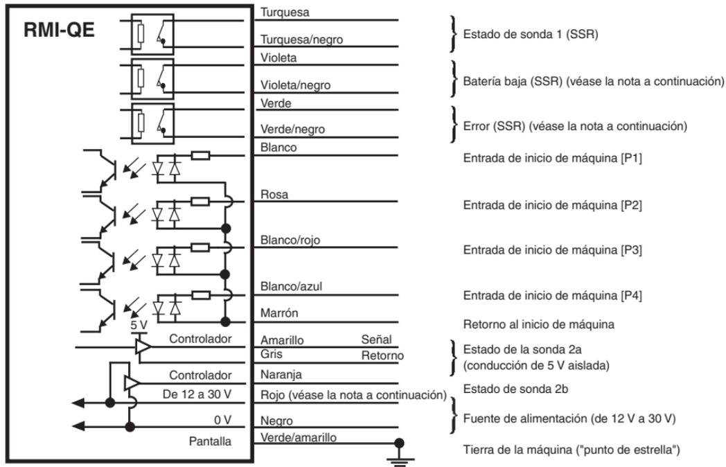
**PRECAUCIÓN:** La fuente de alimentación de 0 V debe conectarse a la toma de tierra de la máquina ("punto de estrella"). Puede utilizar un suministro negativo, con el conexionado adecuado.
