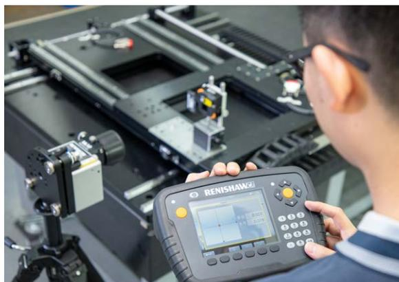
XK10无线显示装置 — 获取和记录测量值并显示实时读数，以便用户即时调整
