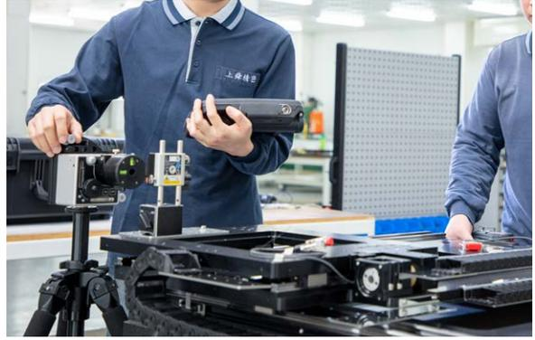
使用XK10激光校准仪对精密线性平台进行验证
