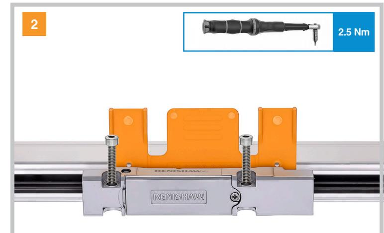
Befestigen Sie den Lesekopf mit zwei M4-Schrauben, während Sie ihn leicht andrücken. Ziehen Sie die Schrauben mit einem Drehmoment von 2,5 Nm fest, um die Installation abzuschließen.
