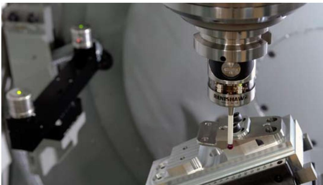
Sistema de reglaje de herramientas sin contacto NC4 de Renishaw para ajuste y detección de rotura de herramientas, y sonda de centrado e inspección de pieza OMP40 para establecer los datos de referencia de la pieza.
