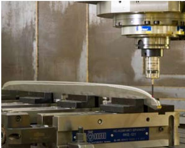
Después de capturar los datos, se crearon los archivos DXF e IGES y se enviaron electrónicamente a Sescoi, que realizó un programa CAD/CAM para el control de máquina Siemens Sinumerik instalado en el centro de mecanizado DMG instalado en los talleres del fabricante de herramientas Iscar. Tras su fabricación, la forma final de las cuchillas se examinó con la sonda de inspección OMP400 de Renishaw, un sistema de detección de esfuerzo que permite realizar mediciones de alta precisión en máquina.
