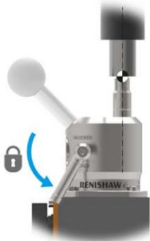
**小心：**使用锁紧手柄将可伸缩柱塞设定就位后，在完成标定并松开锁紧手柄之前，请勿再次按下可伸缩柱塞。可伸缩柱塞可提供10 mm的行程。如果超过此点，则可能会损坏装置。
