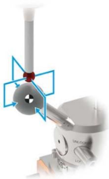
3.5 使用测头测量标定盘，以精确更新X、Y轴基准。（可选）
