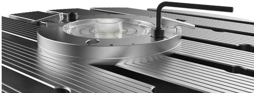
11. Schalten Sie das XR20 ein, um die Akkuleistung zu prüfen: Eine grüne LED zeigt an, dass die Akkuleistung in Ordnung ist. Schalten Sie das XR20 wieder aus, um Akku zu sparen. Wechseln Sie den Akku, wenn die LED gelb leuchtet. Weitere Informationen finden Sie im Abschnitt **Spannungsversorgung: wiederaufladbare Batterie**. Eine ausführliche Liste der LED-Anzeigen finden Sie im Abschnitt **Diagnose und Problembehebung**.
