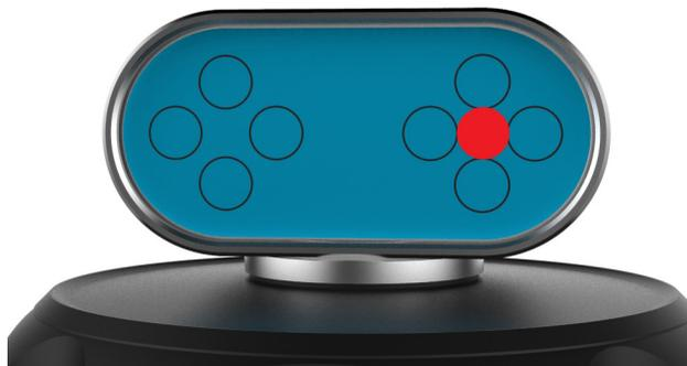
8. Den XL-80 horizontal und vertikal so verschieben, dass der Laserstrahl wie dargestellt auf die Ausrichthilfe trifft:
