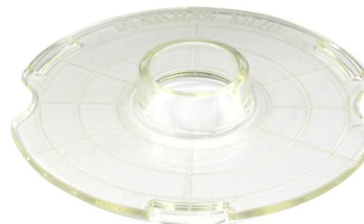
Die Zentrierhilfe vereinfacht die Ausrichtung des Montagerings zentrisch auf der Drehachse der zu prüfenden Maschine, bevor das XR20 Drehwinkelmeßgerät an ihr installiert wird.
