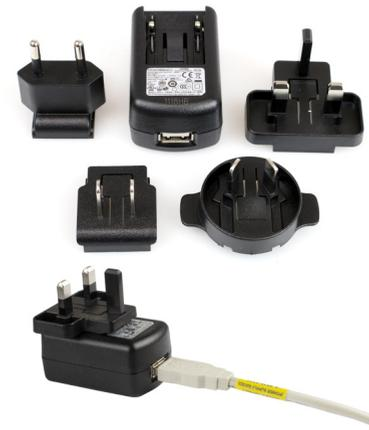
Achten Sie darauf, dass der Stecker des Adapters, an dem das USB-Kabel eingesteckt wird, für Ihr Land geeignet ist. Achten Sie darauf, dass der Adapterstecker richtig eingesetzt ist. Schließen Sie die USB-Spannungsversorgung über das mitgelieferte USB (A-B)-Kabel am USB-Anschluss des XR20 an. Schließen Sie die USB-Spannungsversorgung an eine Steckdose an.
