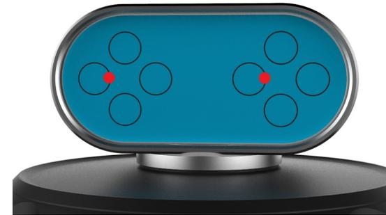
9. Falls erforderlich, die Strahleinheit drehen, bis die Strahlen auf einer Höhe mit dem blauen Messpunkt sind.
