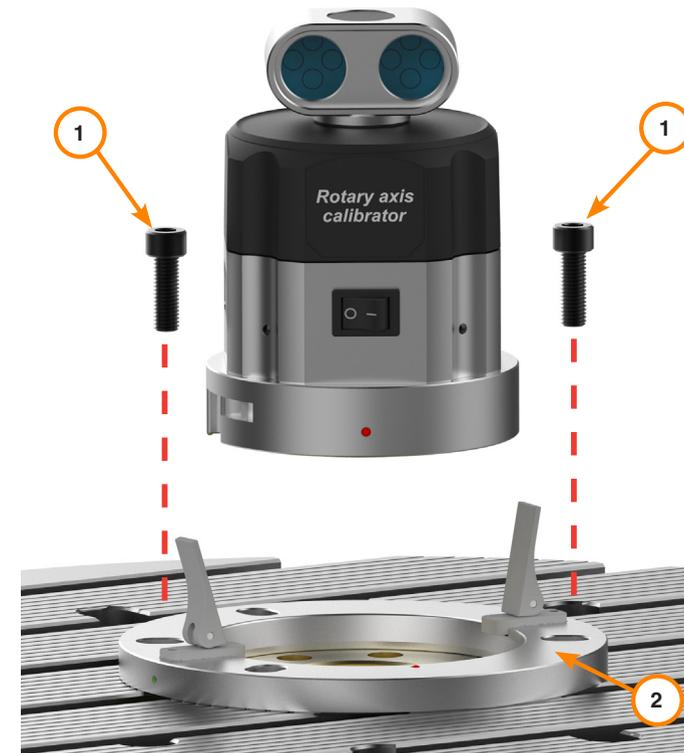
Der Montagering wird mittels der Befestigungsbohrungen in den T-Nuten der Maschine am Tisch verschraubt.
