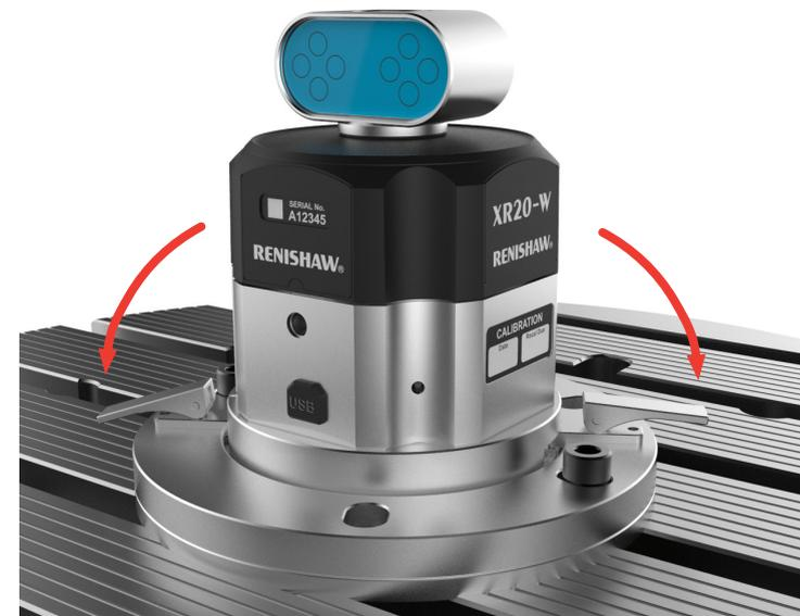
13. Drücken Sie die Klemmenhebel nach unten, um das XR20 zu befestigen.
