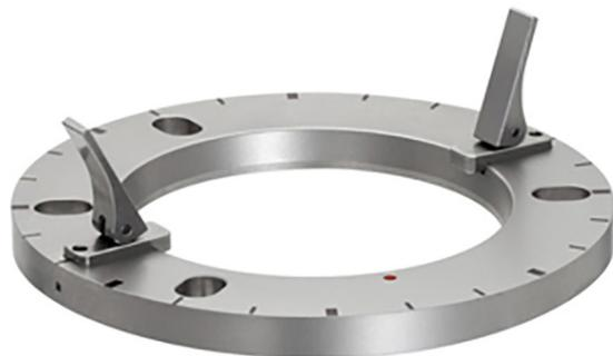
Der Montagering (meist inkl Adapterplatte) wird direkt auf der Oberfläche der Maschine verschraubt oder festgeklemmt und fixiert das XR20 in seiner Position.
