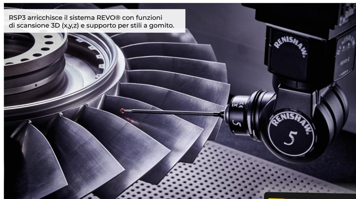
RSP3 arricchisce il sistema REVO® con funzioni di scansione 3D (x,y,z) e supporto per stili a gomito.
