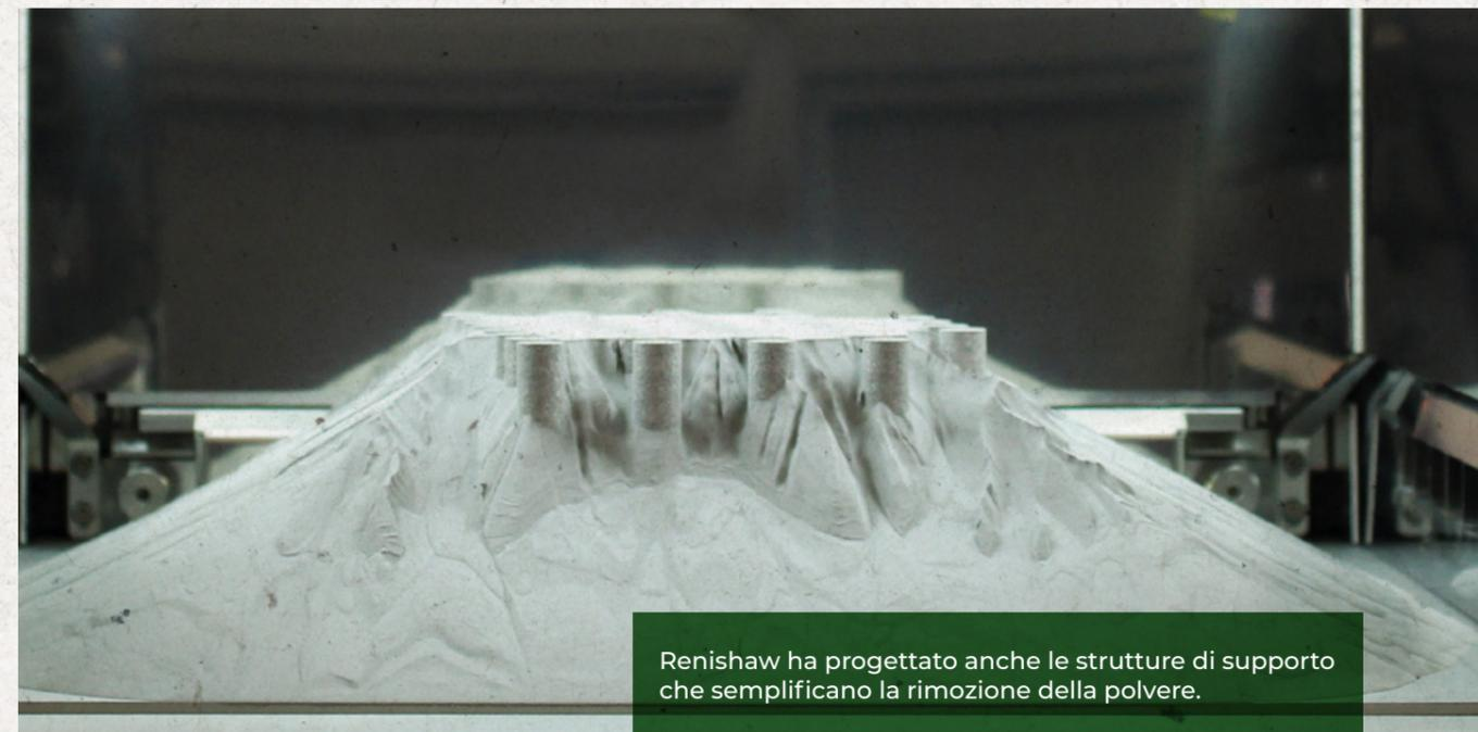
Renishaw ha progettato anche le strutture di supporto che semplificano la rimozione della polvere.
