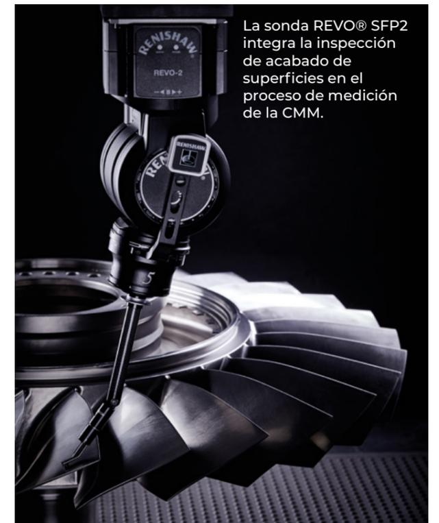
La sonda REVO® SFP2 integra la inspección de acabado de superficies en el proceso de medición de la CMM.
