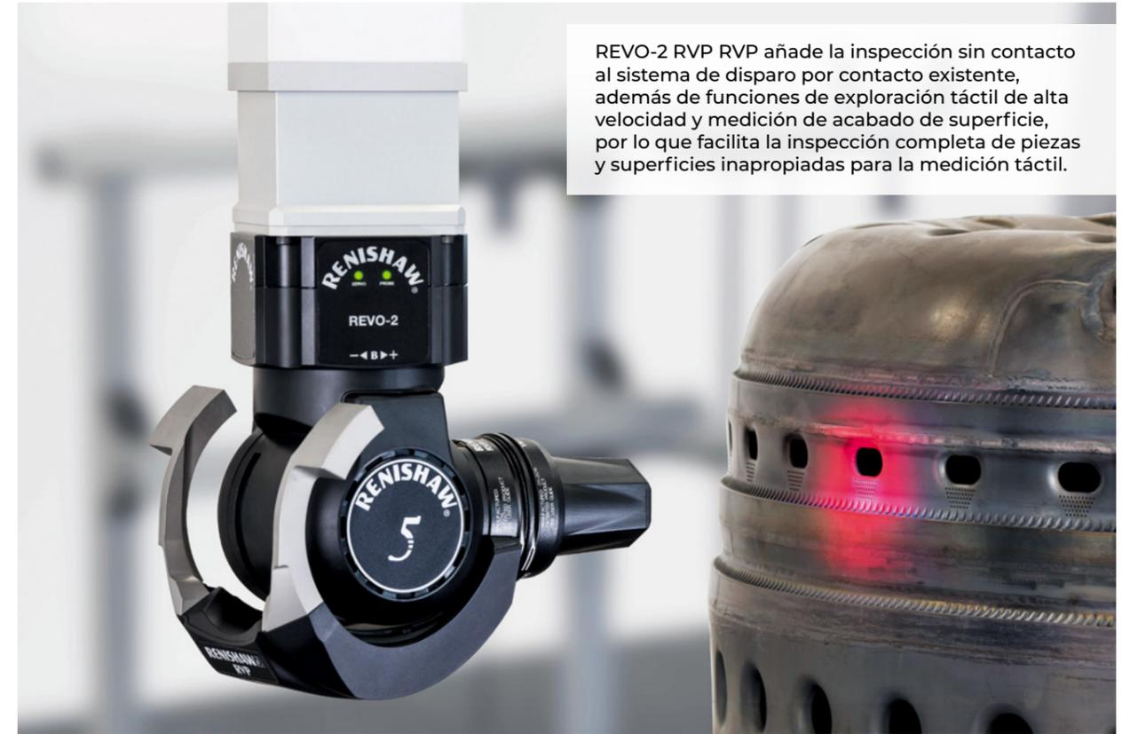
REVO-2 RVP RVP añade la inspección sin contacto al sistema de disparo por contacto existente, además de funciones de exploración táctil de alta velocidad y medición de acabado de superficie, por lo que facilita la inspección completa de piezas y superficies inapropiadas para la medición táctil.
