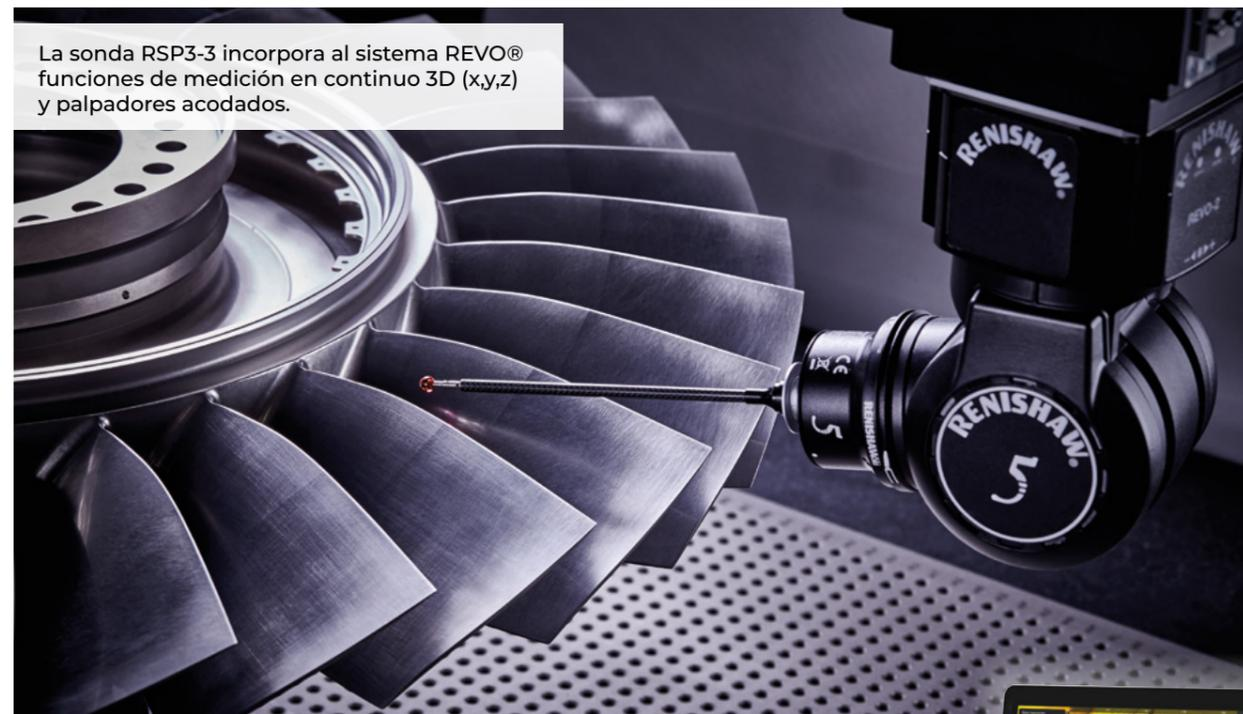
La sonda RSP3-3 incorpora al sistema REVO® funciones de medición en continuo 3D (x,y,z) y palpadores acodados.
