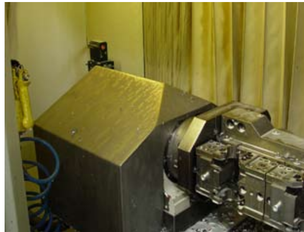
Sistema láser sin contacto de Renishaw montado fuera del entorno de trabajo de la máquina
