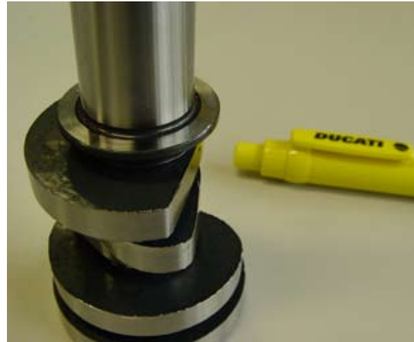
El árbol de levas Desmodromic no es convencional y su diseño incluye 'rampas de elevación' especiales
