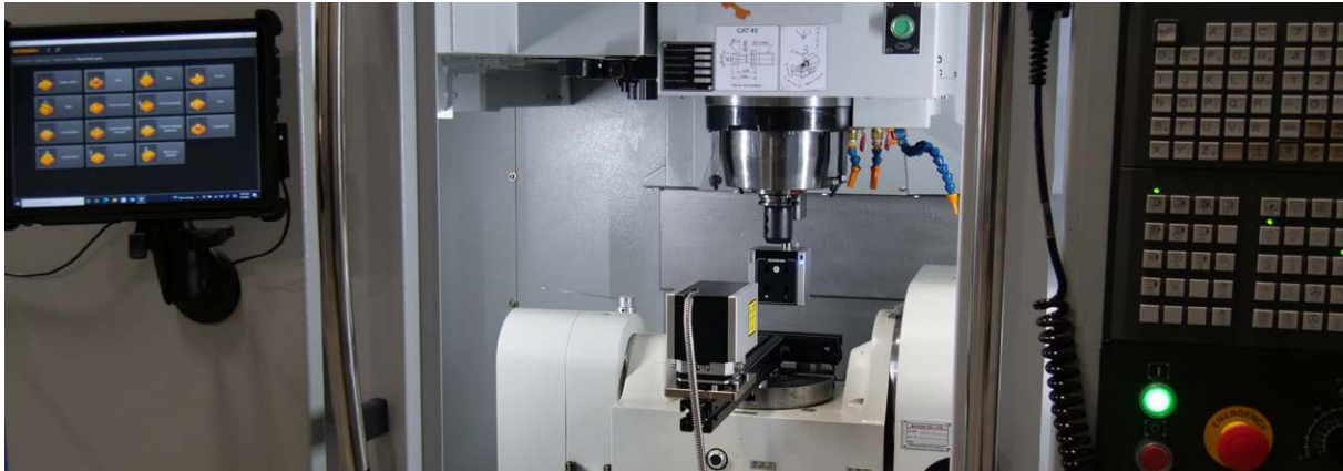
KES wykorzystuje kalibrator XM-60 do wykonywania kompensacji przestrzennej zarówno na obrabiarkach CNC, jak i maszynach współrzędnościowych
