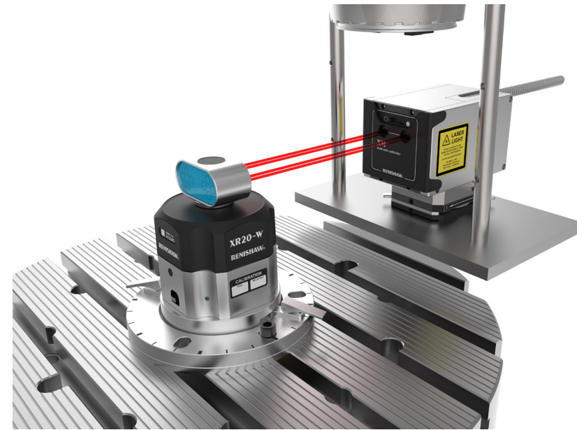
그림 2 XM을 레이저 기준으로 사용하여 로터리 축을 캘리브레이션하기 위한 일반적인 셋업
