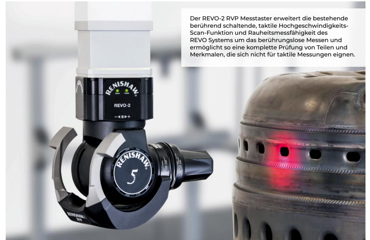
Der REVO-2 RVP Messtaster erweitert die bestehende berührend schaltende, taktile Hochgeschwindigkeits-Scan-Funktion und Rauheitsmessfähigkeit des REVO Systems um das berührungslose Messen und ermöglicht so eine komplette Prüfung von Teilen und Merkmalen, die sich nicht für taktile Messungen eignen.
