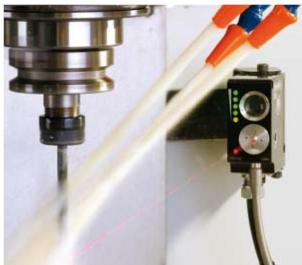
Ad esempio, ora è possibile verificare punte a cannone e ridurre al minimo i tempi di attesa per la decelerazione dei mandrini ad alta velocità. Il TRS2 ha reso più affidabile il rilevamento di utensili piccoli e scuri e ha reso più ampia la gamma di utensili a centro solido rilevabili, inclusi punte, maschi, frese a candela, frese a spianare e frese a testa sferica.
