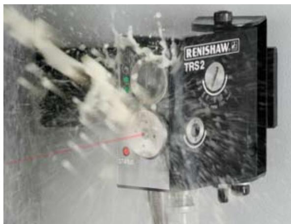
Anche l'impostazione iniziale è semplicissima, grazie al software dedicato. Gli utensili possono essere rilevati a distanze comprese fra 0,3 e 2 metri, in base al tipo di superficie dell'utensile e all'ambiente della macchina. Il sistema TRS2 è ottimizzato per un utilizzo a distanza non superiore al metro, ma risulta comunque compatibile con un'ampia varietà di macchine.
