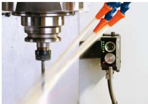
Compuesto por una sola unidad donde se aloja la fuente del láser y el sistema electrónico de detección, el sistema TRS2 puede montarse fuera del entorno de trabajo de la máquina para protegerlo de las colisiones y ahorrar espacio en la mesa de trabajo.
