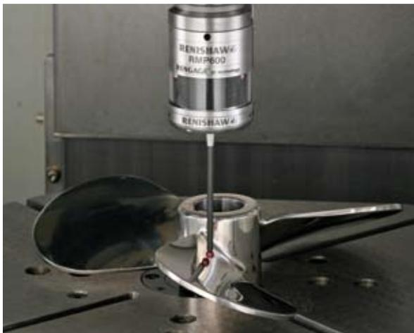
Durch den Einsatz der patentierten Dehnmessstreifentechnologie RENGAGE™ von Renishaw können mit dem RMP600 weitaus genauere Messergebnisse als mit herkömmlich schaltenden Messtastern erzielt werden. Der RMP600 eignet sich daher für Anwendungen, die äußerst präzise Messungen erfordern. Die RENGAGE™-Technologie kombiniert einen patentierten Antastmechanismus mit modernster Elektronik, sodass eine höchst genaue 3D-Messung an Freiformflächen selbst mit langen Tastereinsätzen erzielt werden kann.
