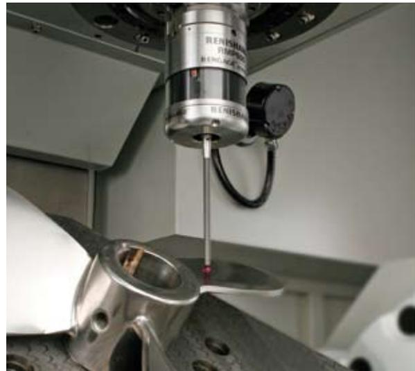
Equipada con un receptor RMI, la sonda RMP600 emite señales a larga distancia con una posibilidad de interferencia imperceptible. Con las transmisiones FHSS para sondas establecidas, las frecuencias del RMP600 y la unidad RMI saltan simultáneamente proporcionando unas comunicaciones fiables. La señal de radio se activa también mediante un código M. El sistema cumple la normativa de radiofrecuencia de la UE, EE.UU., Japón, Canadá, Suiza, Australia y muchos otros países.
