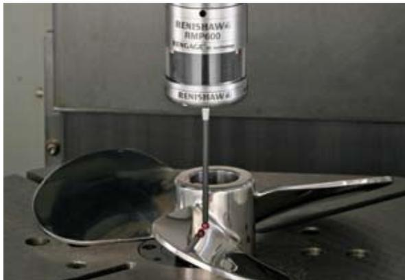
Grazie alla tecnologia estensimetrica brevettata RENGAGE™, RMP600 è in grado di raggiungere un'accuratezza superiore a quella di una normale sonda meccanica, per applicazioni che richiedano la massima precisione. La tecnologia RENGAGE™ combina un meccanismo di rilevamento brevettato a un'elettronica avanzata per ottenere ispezioni tridimensionali con precisione sub-millesimale su superfici sagomate, anche utilizzando stili lunghi.
