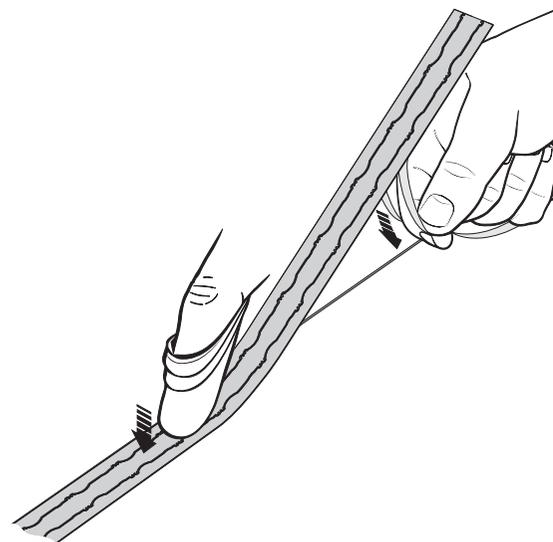
Assicurare la completa adesione al substrato applicando una decisa pressione con il dito lungo tutta la guida *FASTRACK* dal centro verso l'esterno e verso ciascuna estremità utilizzando, se necessario, un panno pulito.
