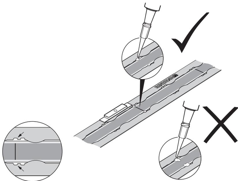
**NOTA:** per un fissaggio ottimale, applicare Loctite 435 solo in questi punti. La Loctite 435 si infiltrerà sotto la riga ancorandola al substrato.
