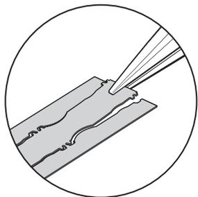
4. Rimuovere la striscia protettiva e incollare la guida *FASTRACK* al substrato, posizionandola contro la spalletta, i bordi in rilievo o le spine.
