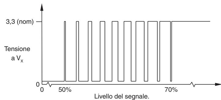
Con un livello di segnale compreso fra 50% e 70%  $V_x$  è un duty cycle.
