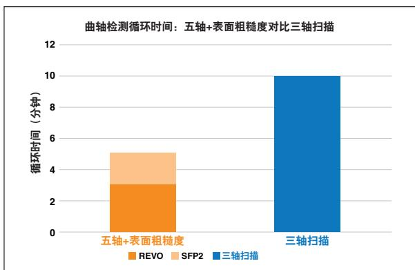
REVO五轴系统集成了尺寸测量和表面粗糙度检测功能，不仅完全免除了手动表面粗糙度检测操作，而且减少了占用的车间空间。此外，多用途夹具和五轴系统不仅可以大幅提升特征测量能力，而且具有以下优势：
