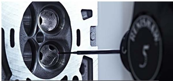
通过在同一台五轴坐标测量机上集成表面粗糙度检测和尺寸测量功能，众多汽车制造商成功将检测循环时间缩短高达50%。
