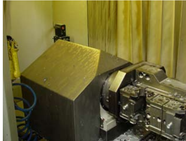
Il sistema laser senza contatto di Renishaw montato all'esterno del campo operativo della macchina
