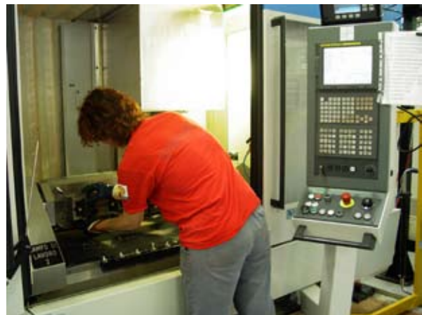
Un operatore è in grado di gestire senza problemi due macchine, limitandosi a caricare i pezzi e ad accertarsi che tutto proceda regolarmente.
