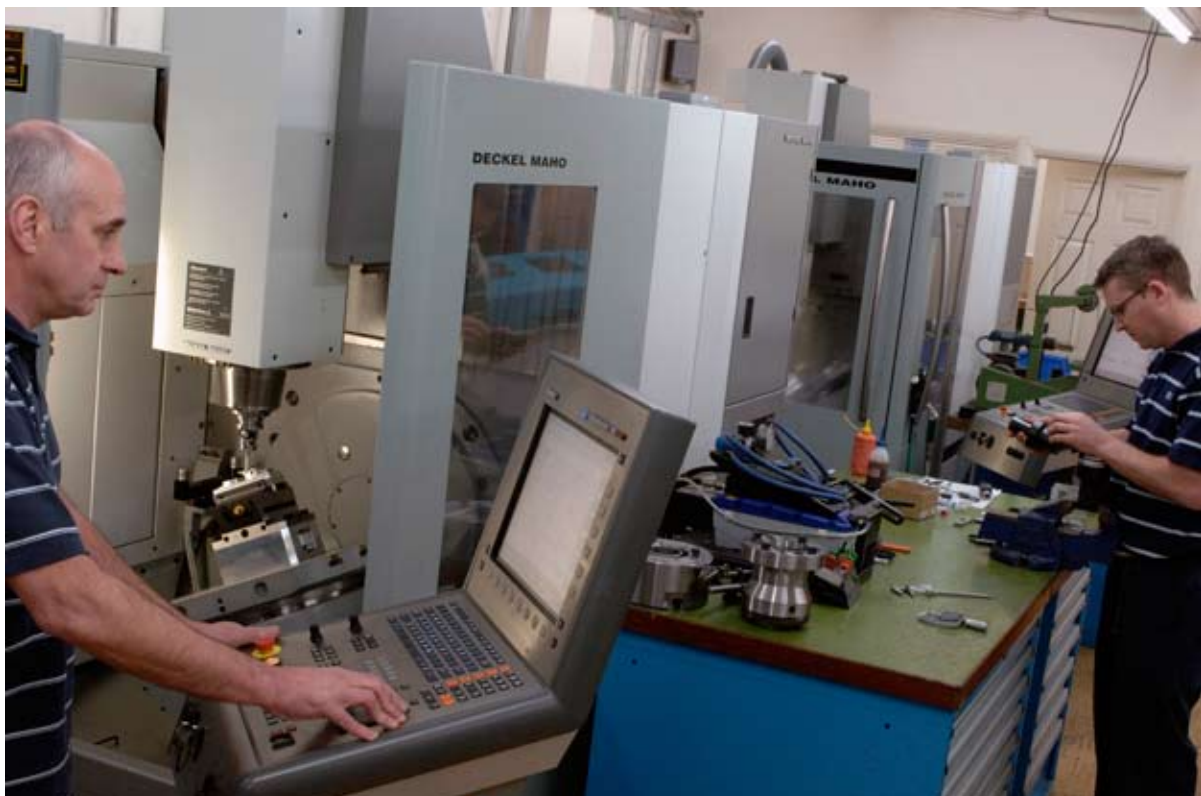
I lavori sono caricati nelle macchine DMG DMU-50 su piccoli pallet e richiedono molti cambi utensile
