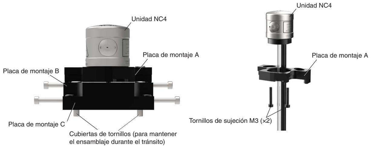
6. Sujete la unidad NC4 en la placa de montaje A con los dos tornillos de sujeción M3.
