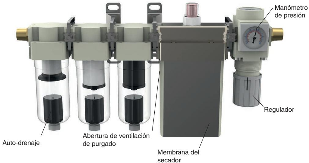
Sujete el paquete de preparación del aire con el soporte de montaje, boca arriba y en vertical, en una superficie adecuada. Debe encontrarse a menos de 25 m del sistema NC4.
