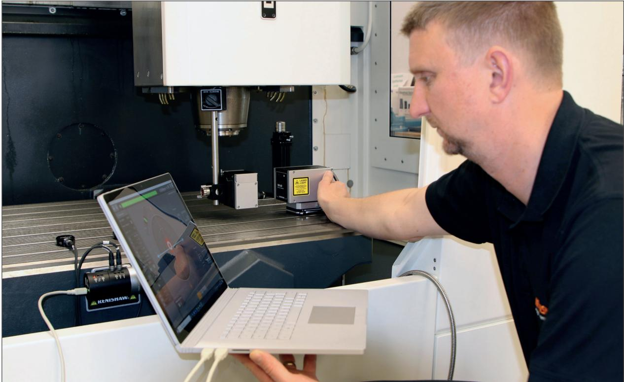
**El calibrador multi-eje XM-60 proporciona amplias funciones de diagnóstico de máquina para la medición de todos los grados de libertad de desplazamiento con una única medición. Con la captura de seis grados de libertad, el operario puede detectar el origen de los errores, en vez del efecto que se obtiene a menudo cuando solo se realiza la medición lineal.**
