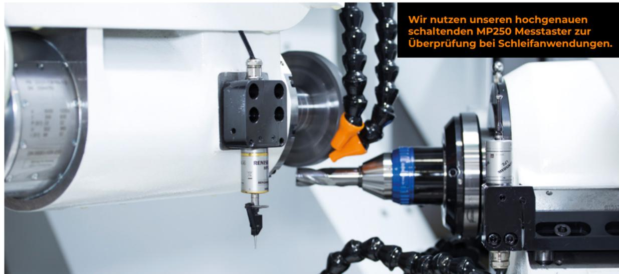
Wir nutzen unseren hochgenauen schaltenden MP250 Messtaster zur Überprüfung bei Schleifanwendungen.
