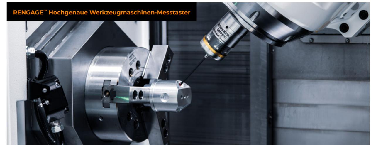
**RENGAGE™ Hochgenaue Werkzeugmaschinen-Messtaster**
