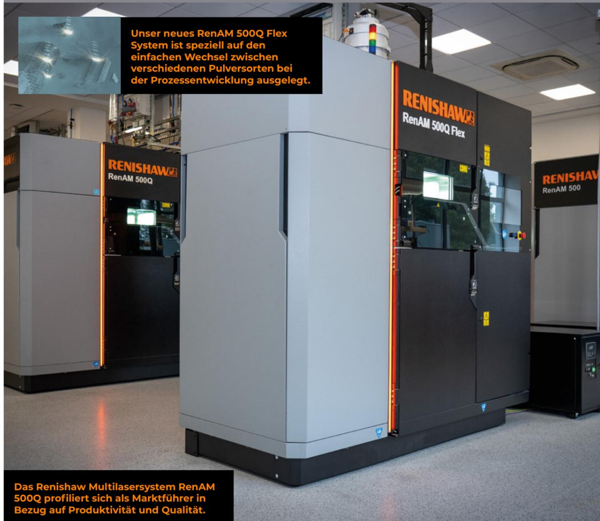
Unser neues RenAM 500Q Flex System ist speziell auf den einfachen Wechsel zwischen verschiedenen Pulversorten bei der Prozessentwicklung ausgelegt.
