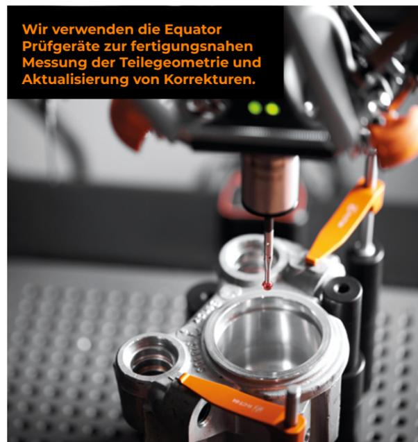
Wir verwenden die Equator Prüfgeräte zur fertigungsnahen Messung der Teilegeometrie und Aktualisierung von Korrekturen.
