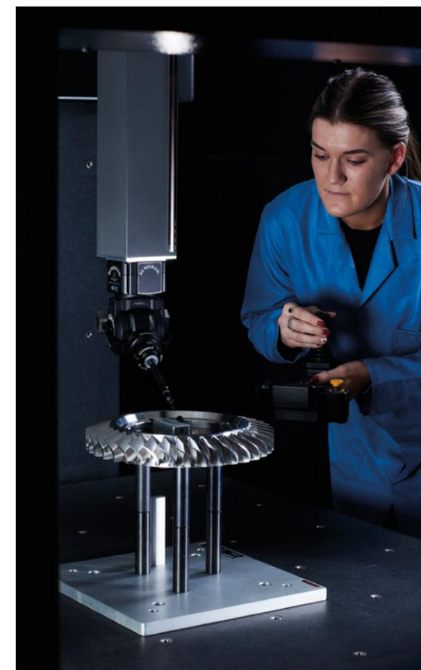
Die Anforderungen an die Fertigung bei Produktinnovationen werden laufend komplexer. Deshalb haben wir in viele unserer Produkte Multisensorfunktionen und die Möglichkeit zur Messung einer Vielzahl von Merkmalstypen aufgenommen. Unsere Messtastersysteme für Werkzeugmaschinen und Koordinatenmessgeräte (KMG) messen beispielsweise die Oberflächengüte und Welligkeit.
