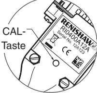
CAL-Taste | Drücken Sie die CAL-Taste auf der Rückseite des Interface < 2 Sekunden lang. Verwenden Sie hierzu einen 2 mm Innensechskantschlüssel o. Ä.<br>
