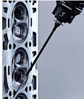
O cabeçote de medição REVO-2 possui tecnologia de mancal pneumático esférico em cada um de seus dois eixos, acionado por motores sem escovas ligados a encoders de alta resolução para fornecer posicionamento rápido e de elevada exatidão.
