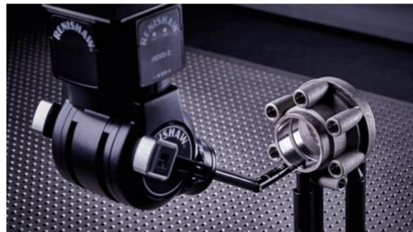
Anche i nostri sistemi di fissaggio possono contribuire a semplificare il setup delle CMM. I sistemi di fissaggio per CMM assicurano un inserimento dei pezzi veloce e ripetibile sul piano della macchina e contribuiscono ad aumentare la produttività e a migliorare la ripetibilità e l'accuratezza dei processi di ispezione.
