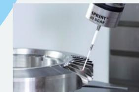
**Tecnologia SPRINT™:** i nostri sistemi di scansione 3D per macchine utensili assicurano velocità e accuratezza e sono in grado di acquisire le superfici a forma libera dei pezzi in macchina per eseguire rapidamente operazioni di impostazione e controllo dei processi di lavorazione.
