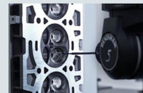
**Sistema di misura REVO® a 5 assi:** questo sistema automatico e multi-sensore è dotato di sonde a contatto e senza contatto per ispezionare pezzi ed elementi su una singola CMM. Può anche misurare le finiture di superficie.
