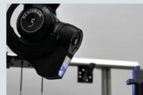
**Tecnologie di ispezione senza contatto:** quando si lavora con pezzi curvi o stampe in metallo complesse, può essere difficile trovare un elemento da usare come riferimento. Le nostre tecnologie di ispezione senza contatto consentono di acquisire una nube di punti 3D della superficie a forma libera.
