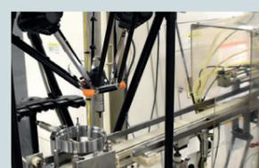
**Sistemas de medição Equator™**: medição rápida e flexível no chão de fábrica para inspeção repetida de características no ponto de fabricação.
