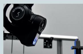
**Tecnologias de medição sem contato**: encontrar uma característica de referência para trabalhar pode ser difícil em peças curvas ou complexas de metal impresso. Use nossas tecnologias de medição com apalpador sem contato para capturar uma nuvem de pontos 3D da superfície de forma livre.
