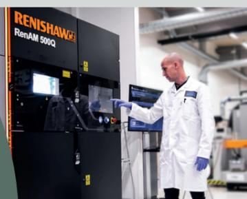
**RenAM 500Q**: O sistema MA quad-laser da Renishaw para altíssima produtividade apresenta quatro lasers de alta potência, que acessam toda a superfície do leito de pó simultaneamente para taxas de construção até quatro vezes mais rápidas do que os sistemas convencionais de laser único.
