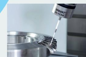
**Tecnologia SPRINT™**: sistemas de medição de máquinas-ferramenta com escaneamento 3D de alta velocidade e elevada exatidão capturam a superfície de forma livre da peça na máquina para a preparação rápida da peça e controle do processo de usinagem.
