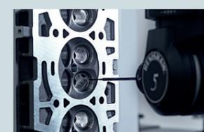
**Sistema de medição em 5 eixos REVO®**: este sistema multissensor automatizado fornece apalpadores de medição com e sem contato para inspeção completa de peças e características em uma única CMM, incluindo medição de acabamento de superfície.
