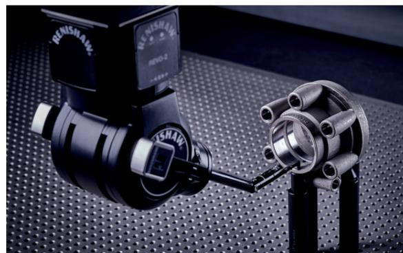
Nossos produtos de fixação também reduzem a complexidade da preparação da CMM. As fixações modulares para CMMs aumentam o rendimento, a reprodutibilidade e a exatidão dos seus processos de inspeção com montagens de fixações rápidas e repetitivas para as suas peças e conjuntos.
