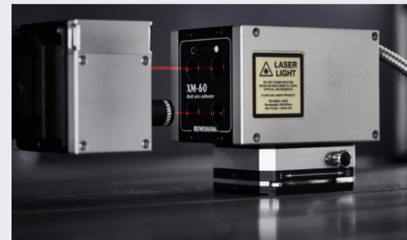
« Nous utilisons le laser de calibration multiaxe XM-60 pour la mesure des axes et la compensation des erreurs sur nos plus grandes fraiseuses à 5 axes. L'avantage : il est capable de réduire les erreurs au sein de la machine, d'où l'obtention de tolérances très serrées sur nos pièces les plus grandes. Le produit est très convivial et permet de compenser facilement plusieurs axes. »
