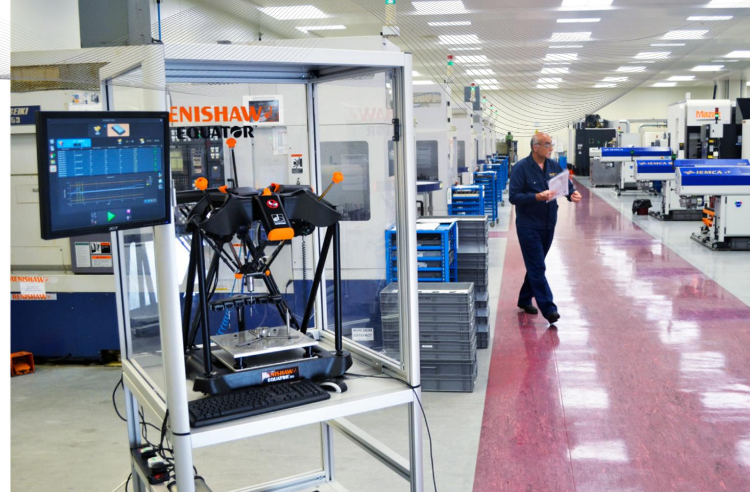
et peut être reprogrammé rapidement pour mesurer de nouvelles pièces ou caractéristiques, sans qu'il soit nécessaire de procéder à un rééquipement fastidieux. Les résultats de la mesure de plusieurs pièces peuvent renvoyer des corrections de décalage à la commande CNC. Cela nous permet d'automatiser entièrement les mises à jour du correcteur d'outil de la machine-outil avec un retour d'information en boucle fermée.
