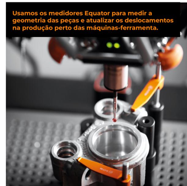
Usamos os medidores Equator para medir a geometria das peças e atualizar os deslocamentos na produção perto das máquinas-ferramenta.
