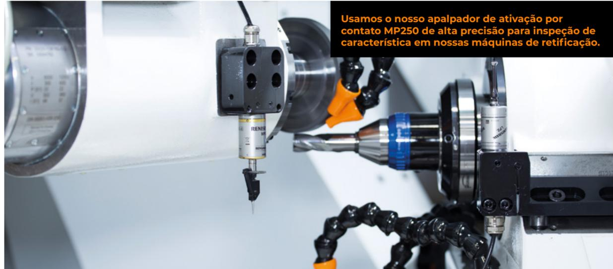
Usamos o nosso apalpador de ativação por contato MP250 de alta precisão para inspeção de característica em nossas máquinas de retificação.
