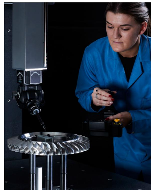
Por exemplo, nossos sistemas de apalpadores para máquinas-ferramenta e máquinas de medição coordenada (CMM) oferecem medições de acabamento de superfície e ondulação.
